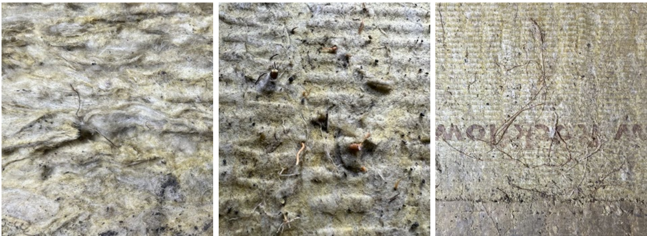
Fig. 10 Von links: Durchwurzelung der obersten, mittleren und unteren Steinwollen.
