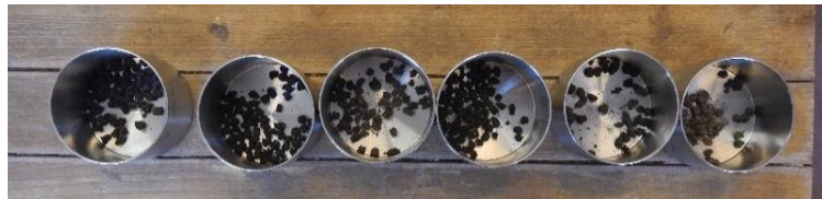
Figure 2 – Dispositif Eijkelkamp de tamisage humide (WSA) pour la détermination de la stabilité des agrégats
