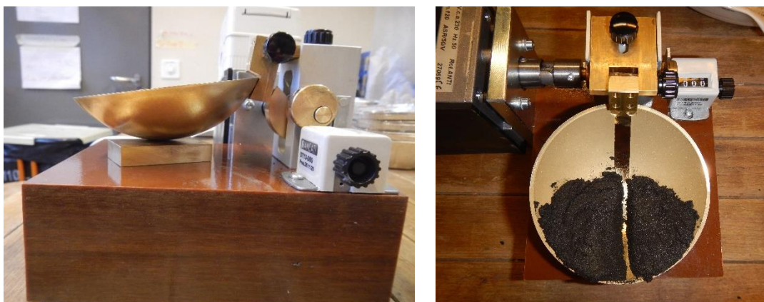
Figure 6 – Détermination de la limite de liquidité: Bol de Casagrande
