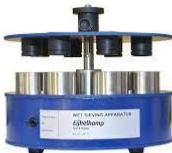
Figure 10 – Dispositif Eijkelkamp de tamisage humide pour la détermination de la stabilité des agrégats
