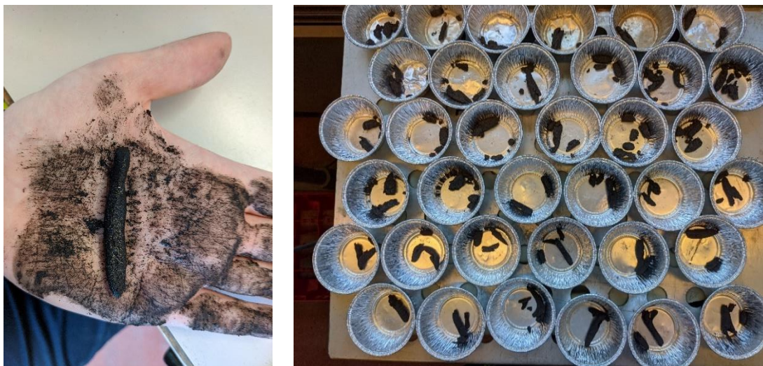
Figure 8 – Limite de plasticité: Test du boudin
