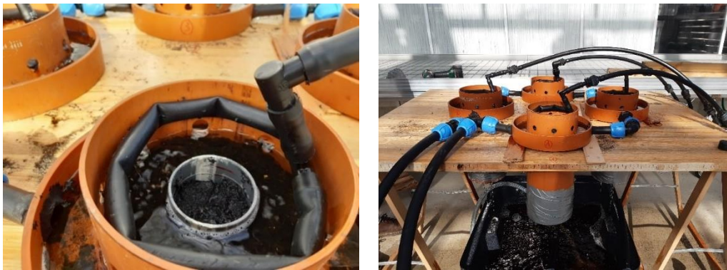
Figure 1 – Méthode du double anneau pour mesure de perméabilité à saturation
