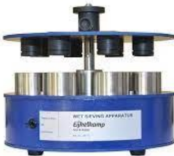
Figure 2 – Dispositif Eijkelkamp de tamisage humide (WSA) pour la détermination de la stabilité des agrégats
