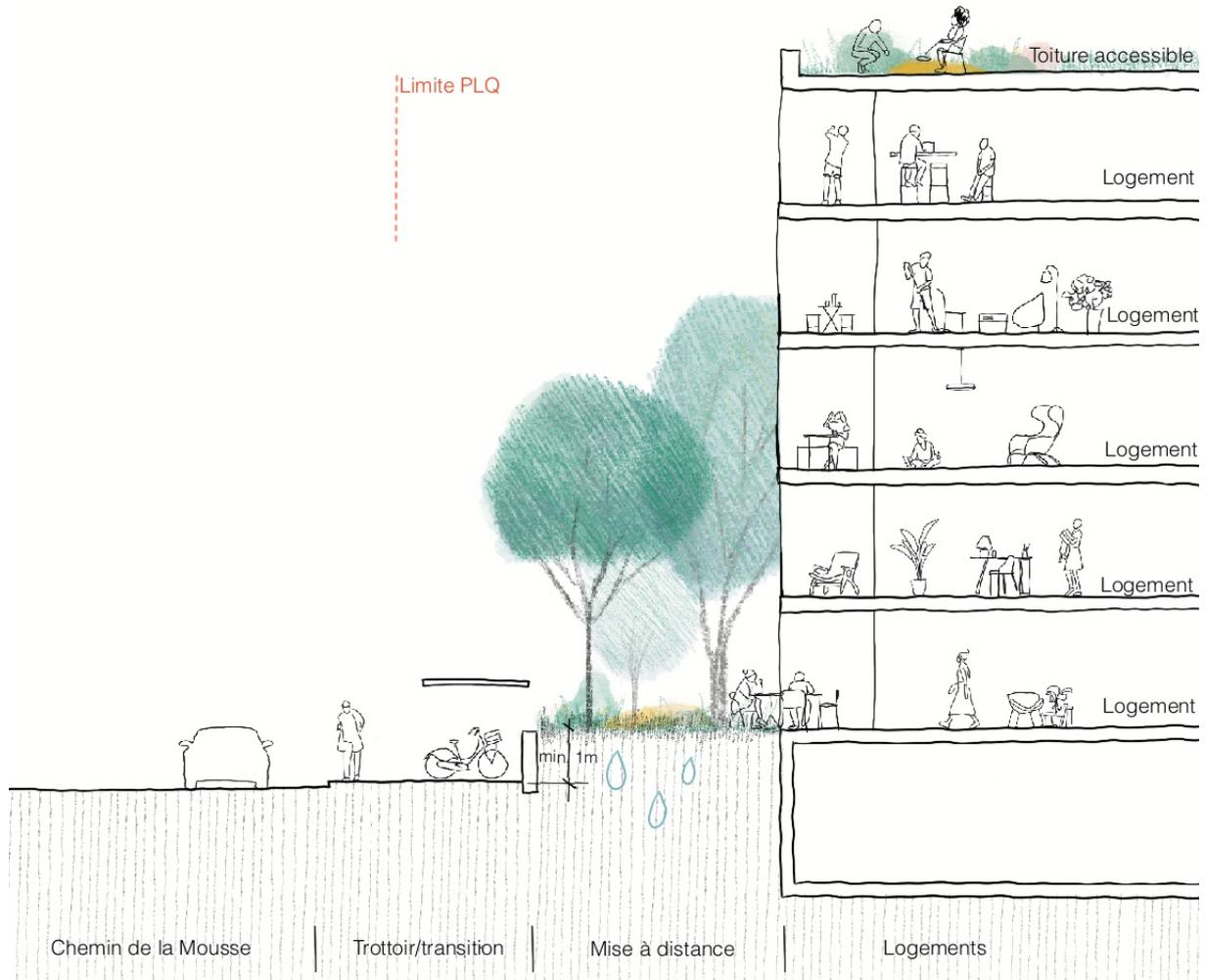
Coupe XX dans le dispositif de mise à distance avec le chemin de la Mousse
