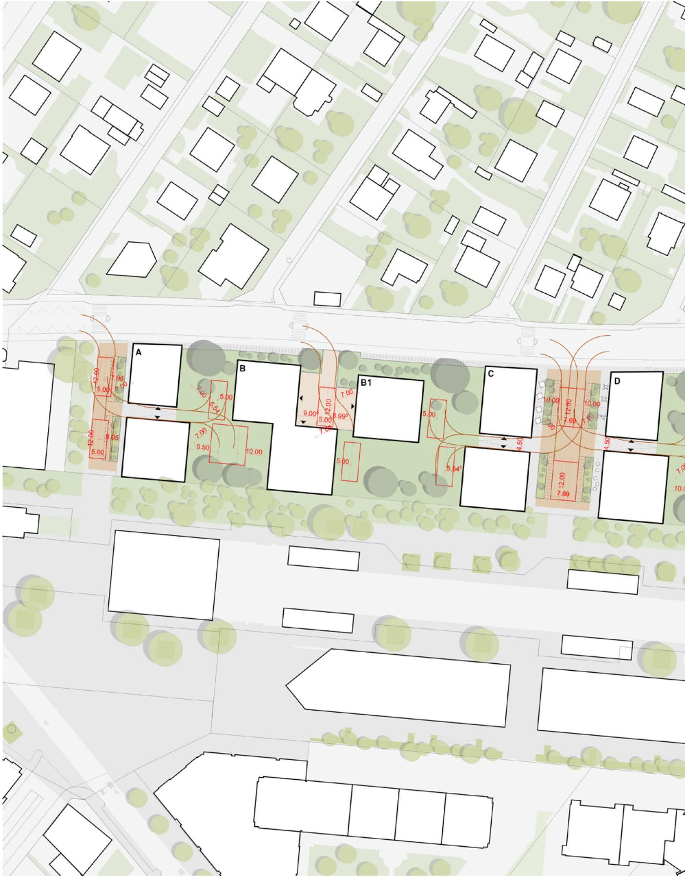
Schéma de circulation et intervention de véhicules SIS
