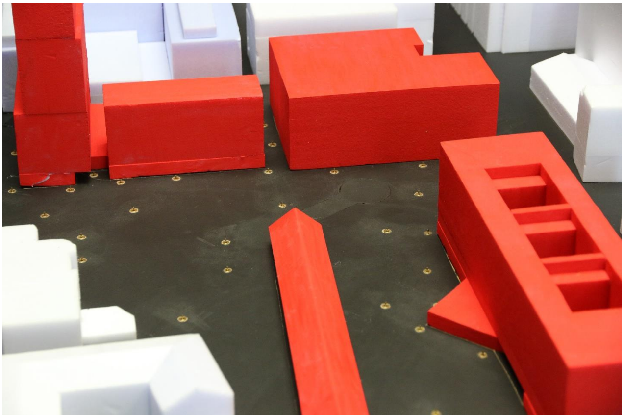
Abb. 2.6: Detailaufnahmen des Windkanalmodells mit Geschwindigkeitssensoren (Irwin-Sonden) im bodennahen Außenbereich
