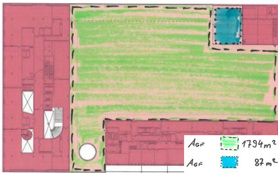
Abb. 60: Als Terrasse nutzbare Fläche auf Flachdach im Teilgebiet B, ABZ, Mai 2020
