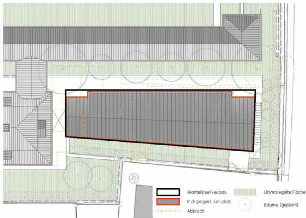
Abb. 32 Gebäudemantel mit Dachaufsicht Richtprojekt
