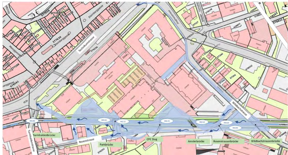
Abbildung 7: Ausschnitt der Amtlichen Vermessung im Projektperimeter mit heutigen Fließwegen und abgeschätzten Überflutungsflächen (blau, transparent) im HQ100. Die Abflusstiefen auf der Technikumstrasse wurden nicht im Detail untersucht
