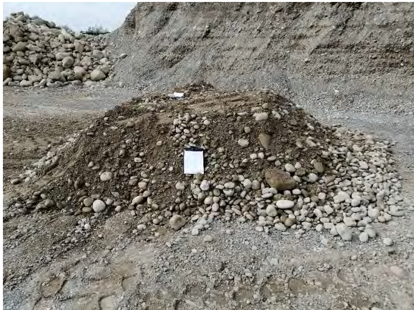
Abbildung 19: Sohlsubstratmischung Nr. 4: Sandiger Grobkies mit Bollensteinen, mit einem A4-Blatt als Grössenvergleich
