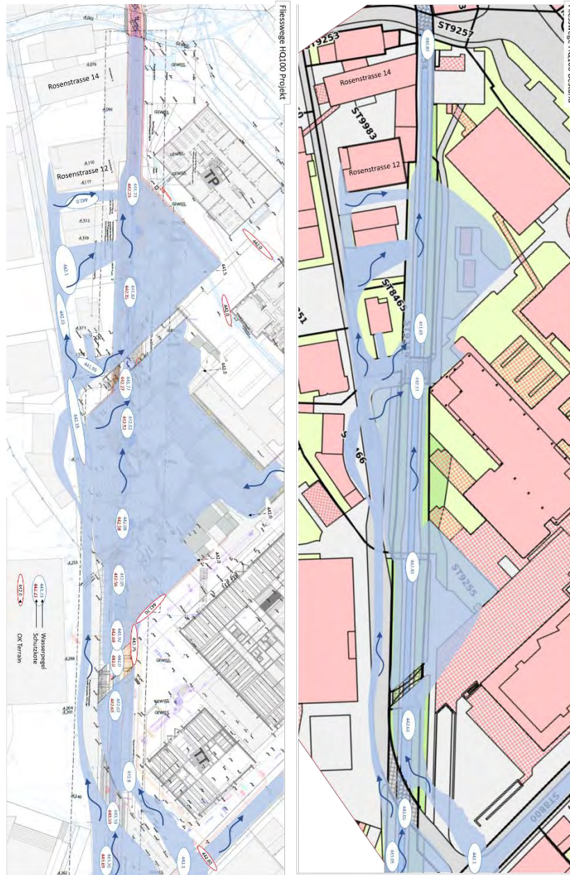
Abbildung 25: Ausschnitt der Situation vor (rechts) und nach Projektumsetzung (links) mit Fliesswegen und abgeschätzten Überflutungsflächen (blau, transparent) im HQ 100 . Rote Zahlen bezeichnen die Schutzkote am Gewässer gemäss Freibordpapier des Kanton Zürich.
