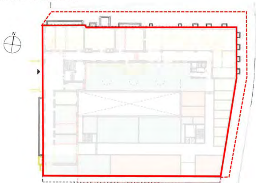
Abbildung 12: Mobile / Teilmobile Schutzmassnahmen an den Öffnungen am Gebäude TE, allenfalls kombiniert mit einer mobilen Abschirmung (gestrichelt) garantiert den Schutz gegen das EHQ. Als Schutzkote angegeben ist hier der Maximalwert am Gebäude (Tabelle 2).
