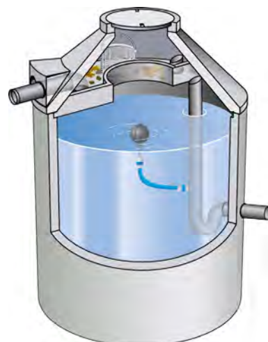
Abb. 79: Zisterne mit Retentions- und Speichervolumen
