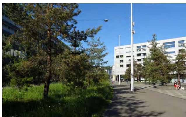
Abb. 53: Bepflanzte Mulden nehmen bei Starkniederschlägen das Wasser am Turbinenplatz auf.
