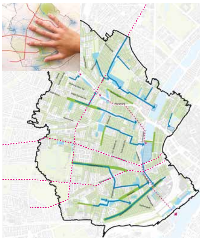
Abb. 16: Der «Fingerstrukturplan» zeigt auf, wie das Wasser bei Starkniederschlag abfließt.
