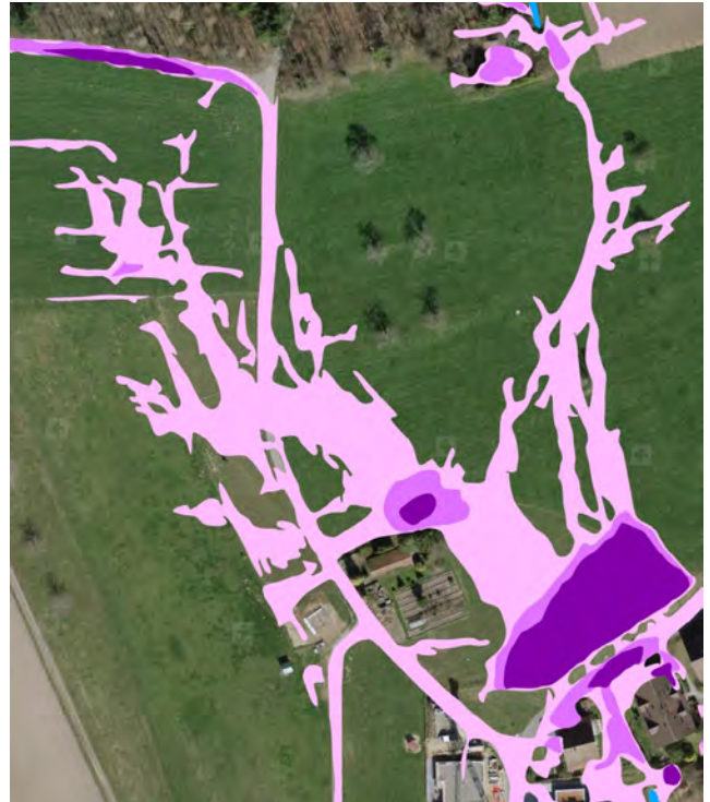
Abb. 25: Gefährdungskarte Oberflächenabfluss beim eingedolten Buechbach: blau die offenen Abschnitte; grosse, dunkelviolette Fläche unten rechts das Rückhaltebecken
