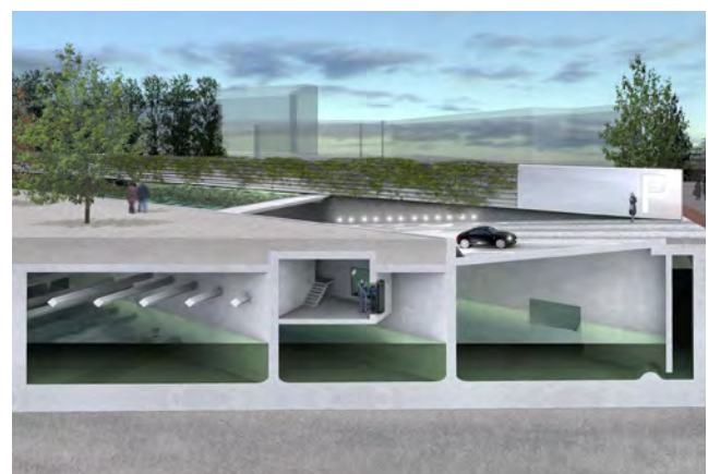
Abb. 69: Schematischer Schnitt der Tiefgarage mit Retentionsvolumen
