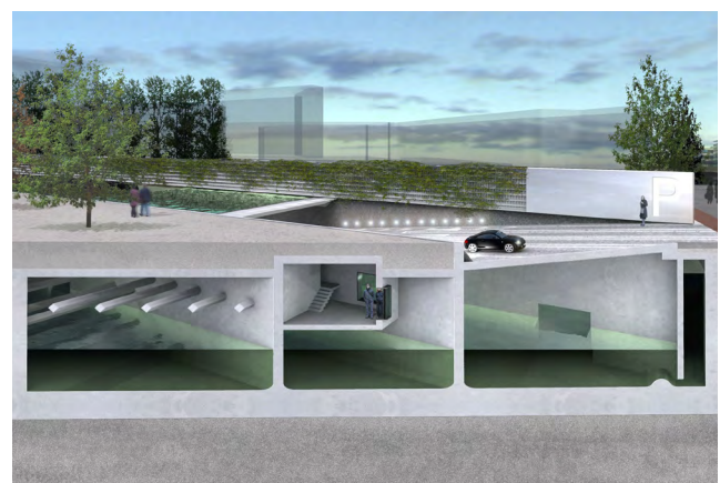
Abb. 69: Schematischer Schnitt der Tiefgarage mit Retentionsvolumen
